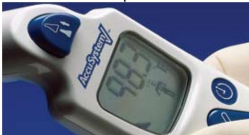
Para cambiar la pantalla de temperatura, presione y sostenga el botón C/F° por 2 segundos cuando la pantalla LCD esté activa.
