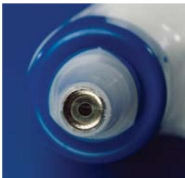
Inspeccione la membrana en el extremo de la cubierta del sensor. Si se observa algún orificio o rotura, deséchela y coloque una cubierta de sensor nueva.
