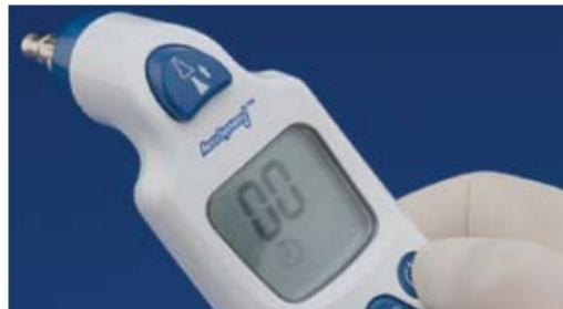
Para usar el temporizador de pulso de 60 segundos, presione y sostenga el botón del icono del reloj por dos segundos para activarlo.
