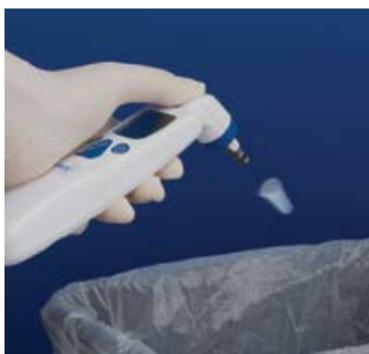
Deseché la cubierta del sensor en un depósito de basura presionando el botón de expulsión.
