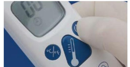
Presione y libere el botón del icono del reloj una vez y comience (se escucharán pitidos en intervalos de 15 segundos), éste se apagará automáticamente a los 60 segundos. Si termina con la función antes de completar los 60 segundos, presione y libere el botón del icono del reloj una segunda vez para desactivar la función.
