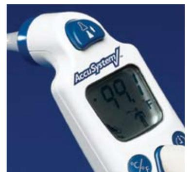
Para regresar a la última temperatura, presione y libere el botón de escaneo antes de colocar otra cubierta del sensor. Al colocar una nueva cubierta del sensor se borrará de la memoria la última temperatura que tomó.
