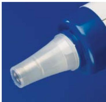
Asegúrese de que la cubierta del sensor esté a ras con el casquillo azul del extremo. No se debe ver el sensor plateado. DEBE usar una tapa sonda.
